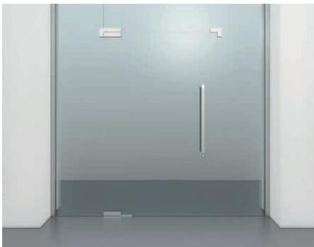
Tous les modèles sont équipés de réglages en continu de la vitesse de fermeture et l'à-coup final. Force 4 d'après EN 1154. Grâce à l'axe à cames unique, monté sur roulements, les pivots de sol peuvent être ouverts par une pression manuelle très faible (2,75 Kg) et conviennent donc parfaitement pour personnes handicapées, âgées et aux enfants. Pour portes pivotantes.
