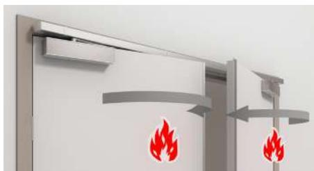
Le rail est équipé d'un sélecteur de fermeture pour assurer le bon ordre de fermeture des deux vantaux. Le rail peut également être équipé avec un arrêt électromagnétique sur les deux vantaux, qui sont désactivés en cas d'incendie, permettant aux ferme-portes de fermer automatiquement les portes.
