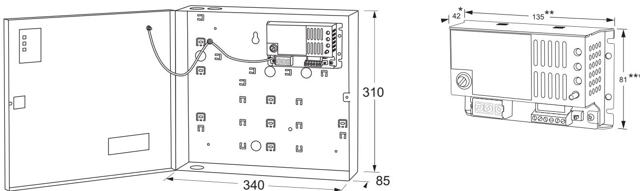
Met DIN rail adapters / With DIN rail adaptors / Avec adapteurs rail DIN / Mit Hutschienen Adapter:
