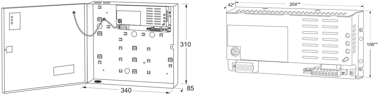
Met DIN rail adapters / With DIN rail adaptors / Avec adaptateurs rail DIN / Mit Hutschienen Adapter:
